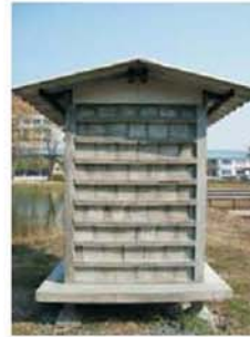
คอนกรีตบล็อกเพื่อลดการสะสมความร้อนด้วยวิธีธรรมชาติ i-c block รางวัลชนะเลิศนวัตกรรม มก. ปี 2552
